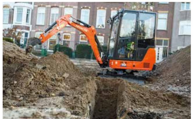
Durch den obenliegenden Auslegerzylinder werden Ausfallzeiten aufgrund des reduzierten Kontakts mit dem Zylinder reduziert.
