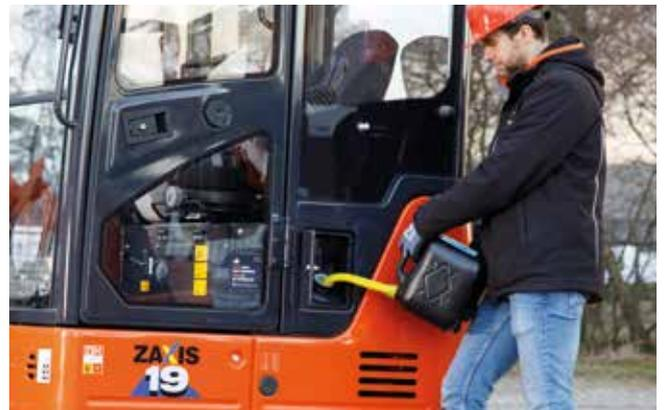
Die gut positionierte Kraftstofftanköffnung ermöglicht einfaches Auftanken.
